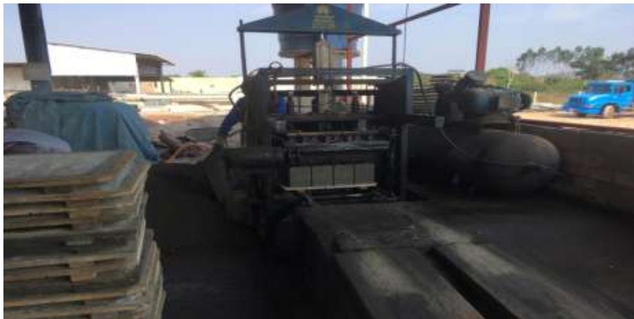
[...] Máquina Bloquera de Blocos sobre Pressão
