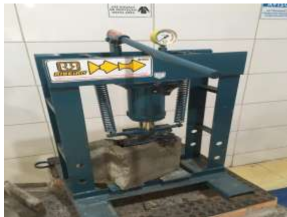
[...] teste de resistência do bloco.
