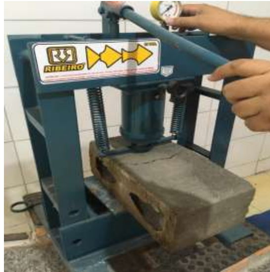
[...] teste de resistência do bloco.
